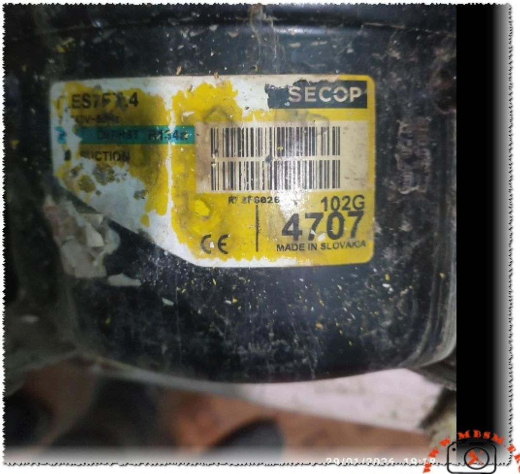
1/5 hp, [102G4707](#), [EMT6170Z](#), [ES7FT.4](#), [GL70AA](#), [LBP compressor](#), [mbsm](#), [mbsm.pro](#), [mbsmgroup](#), [mbsmpro.com](#), [ND1111Y](#), [R134a](#), [Refrigerator Repair](#), [Secop](#), [THG1365Y](#), [TLS7F](#)
