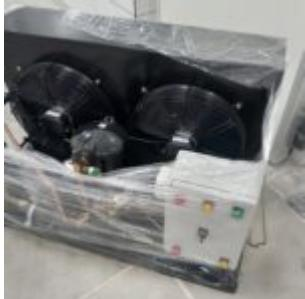
ZB38 5HP R404 MBP correspond à un compresseur scroll Copeland Emerson, modèle ZB38KQE ou ZB38KCE, puissance nominale 5 HP, conçu pour le fluide frigorigène R404A et destiné au service moyenne température (MBP = Medium Back Pressure).
